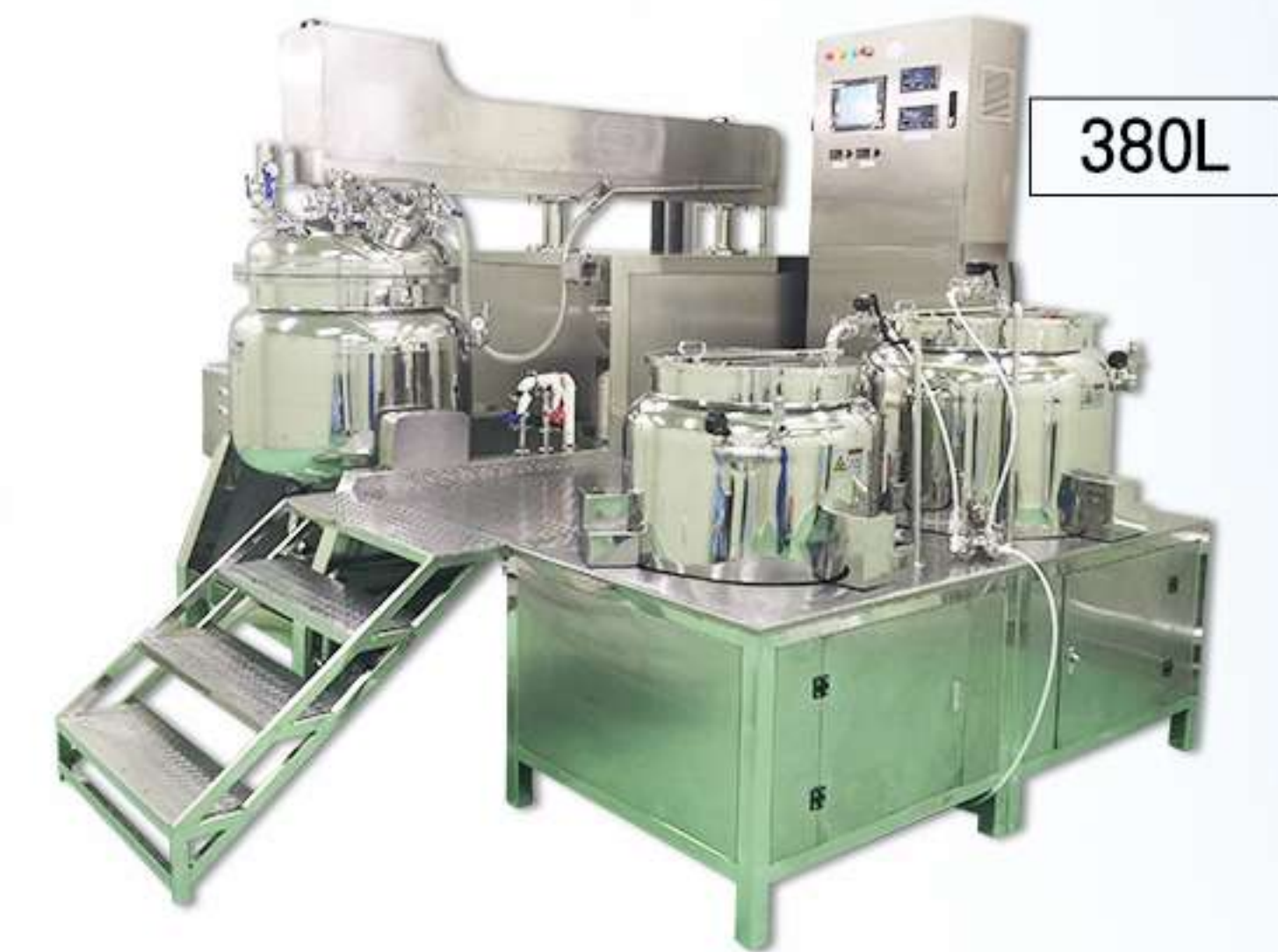
液壓升降真空乳化(2號機)
